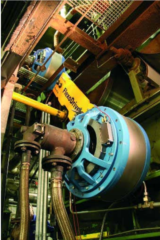
Abb. 4: Hohlwellendirektmotor FlexoDrive® mit je 35 kW
