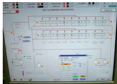
Prozessleitsystem mit der Darstellung von 18 AS-Transfuser-Systemen im Trockenteil.
